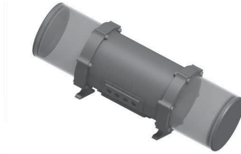
Şekil 5. Otonom su altı aracı ana gövdesi
