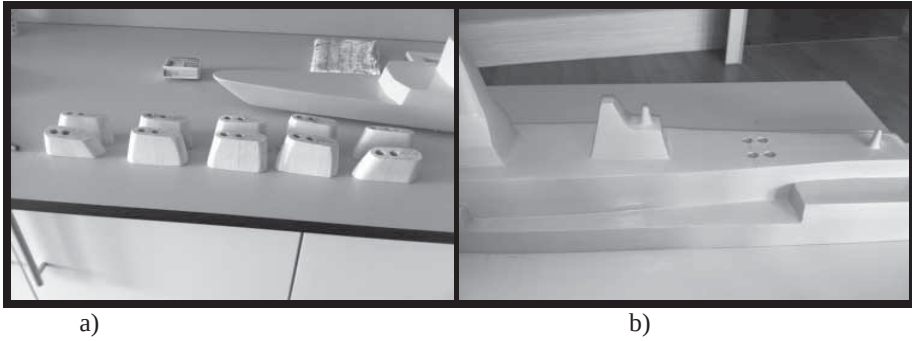
Şekil 13 : 1/100 ölçekli fırkateyn modeli a) Farklı baca geometrileri b) Egzoz çıkışları.
