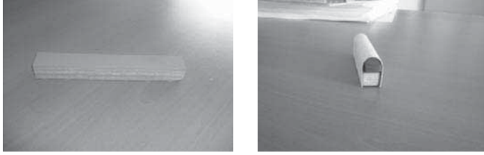
Şekil 3. Darbe deneyi için hazırlanan numuneler
