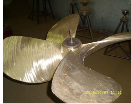
Fotoğraf 2. Ercan Torna ‘da solda dökümden gelmiş dört kanatlı bir baş itici pervanesi ve sağda döküm sonrası iki kanadı işlenmiş pervane görülmektedir. (Fotoğraflar Ercan Torna izni ile basılmışlardır.)
