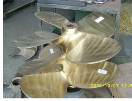
Fotoğraf 3. Gürtaş Mühendislik ‘te solda dökümden gelmiş bir pervane ve sağda döküm sonrası işlenmiş pervaneler görülmektedir. (Fotoğraflar Gürtaş Mühendislik izni ile basılmışlardır.)
