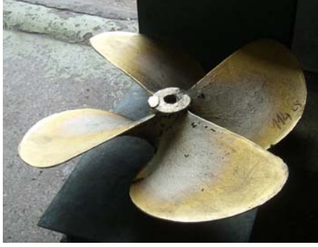
Fotoğraf 3. Gürtaş Mühendislik ‘te solda dökümden gelmiş bir pervane ve sağda döküm sonrası işlenmiş pervaneler görülmektedir. (Fotoğraflar Gürtaş Mühendislik izni ile basılmışlardır.)
