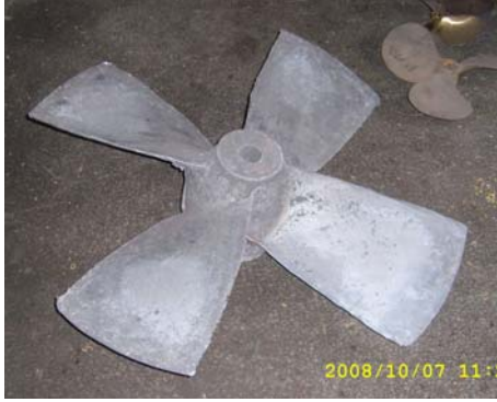
Fotoğraf 2. Ercan Torna ‘da solda dökümden gelmiş dört kanatlı bir baş itici pervanesi ve sağda döküm sonrası iki kanadı işlenmiş pervane görülmektedir. (Fotoğraflar Ercan Torna izni ile basılmışlardır.)
