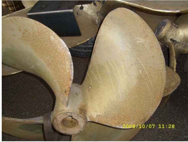
Fotoğraf 4. Yanlış seçim yapıp tamir sırası bekleyen bir pervane. Pervane kanadının sırt tarafının yaklaşık %50 ‘si yüksek kavitasyondan zarar görmüştür. (Fotoğraf Ercan Torna izni ile basılmıştır.)
