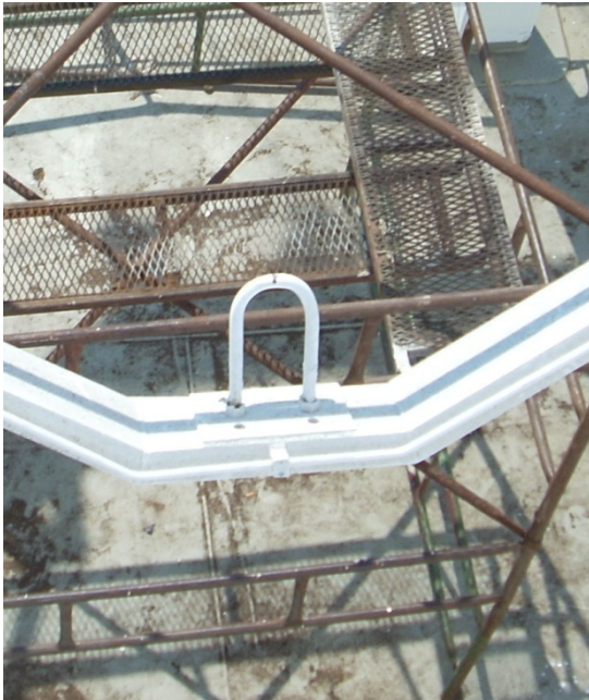
Filika mataforasındaki kord nozullu dümen topuğunun çarpmasıyla hasarlanan deniz bağı kelepçesi
