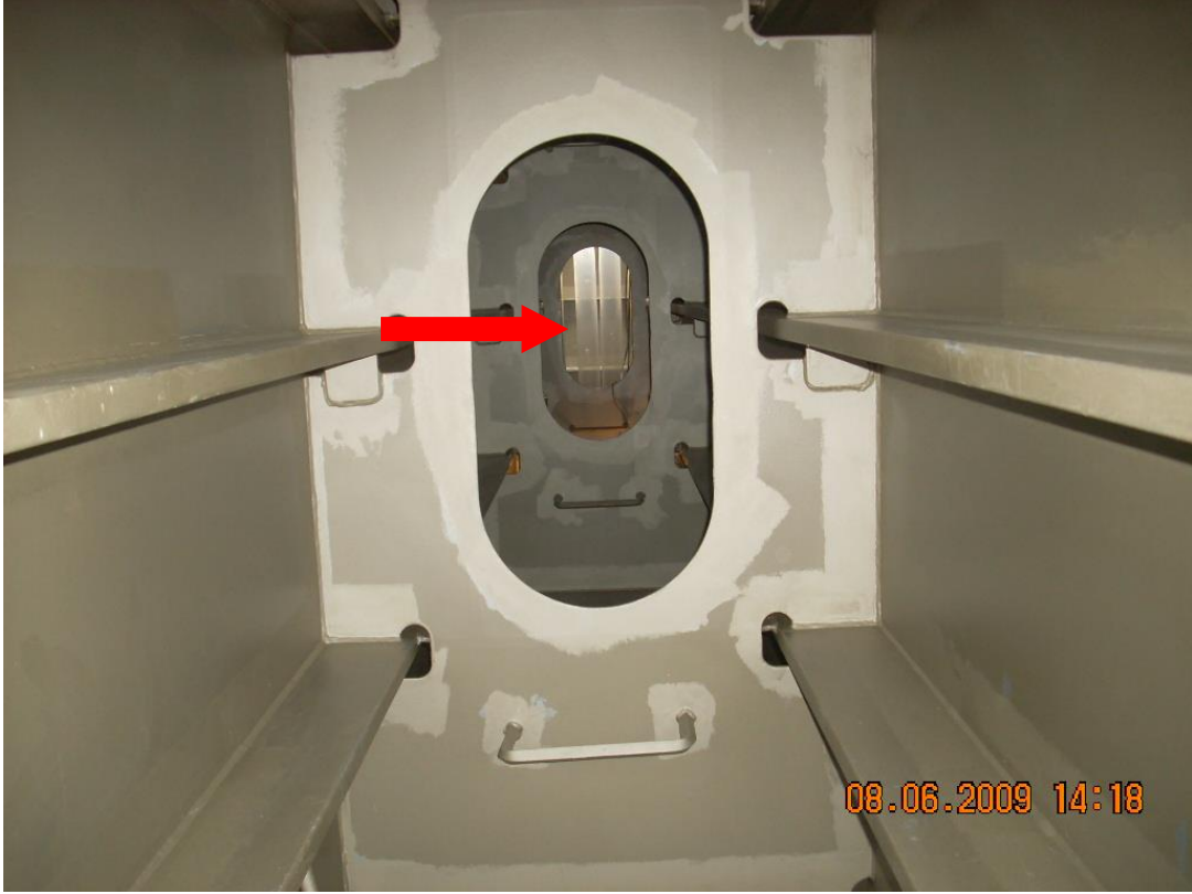
Boyamadan önce tankın içinden görüntü. Tankın ana hacminde baş taraf menholünden iki adet taze hava basma hortumu görülüyor
