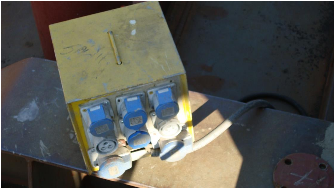
Tersanede kullanılan 24 V AC aydınlatma trafoları
