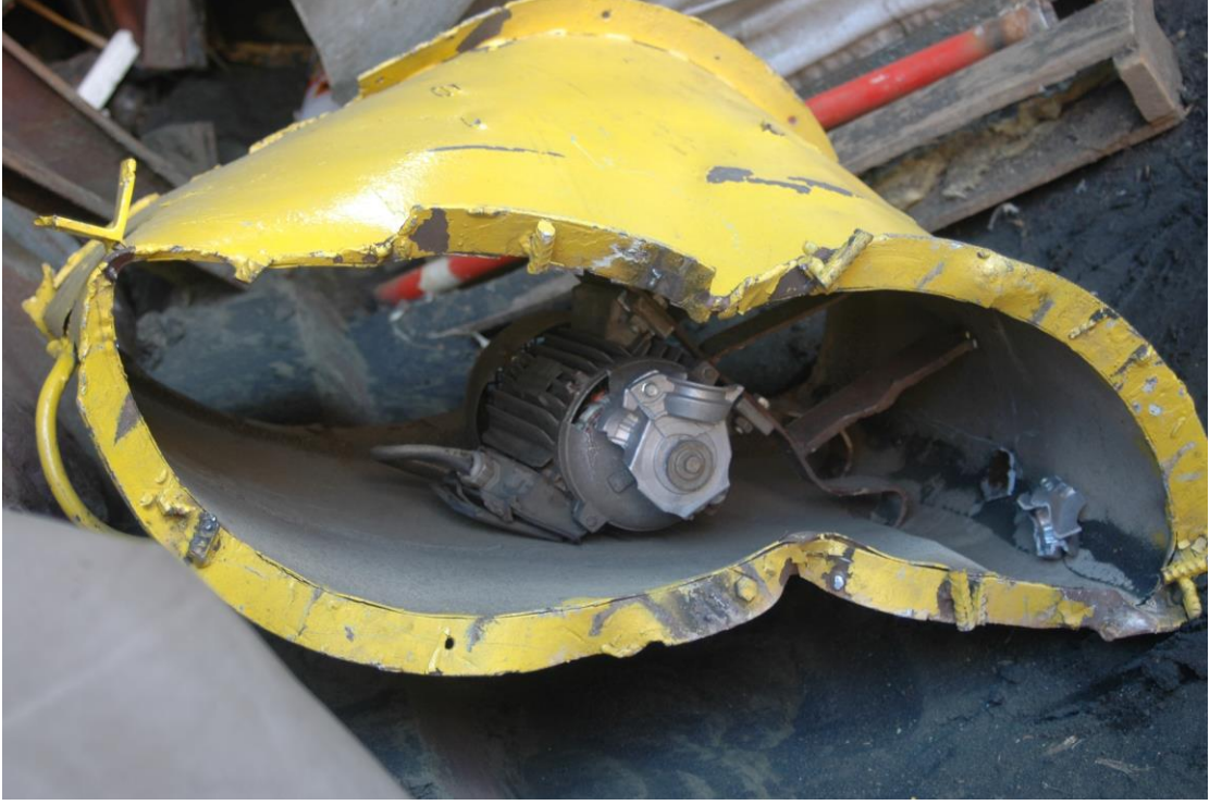
Parçalanmış olan fanın görüntüsü; kararma yanma belirtisi yok, havaya uçmanın etkisi ile parçalanmış.
