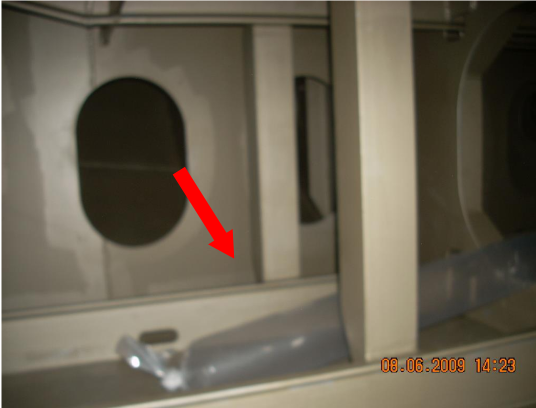
Boyamadan önce tankın içinden görüntü. Çift dip dibinde ucu bağlı vaziyette taze hava hortumu görülüyor
