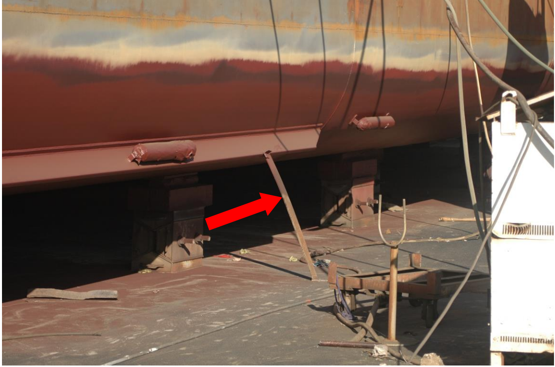
Geminin uygun bir topraklama laması ile toprak hattına bağlandığı ve gemi bünyesi ile toprak arasında yeterli iletim olduğu görülmüştür.
