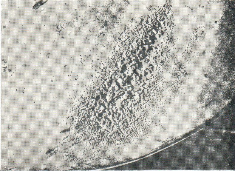
ŞEKİL 1— Kanat sırtında sınırlı lokal kaviteasyon erozyonu.
