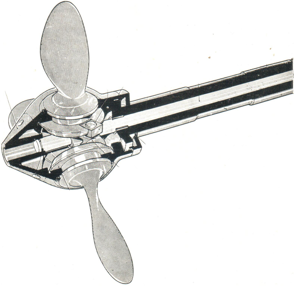
Şekil : 16 — Lips (Hollanda) itme çekme şaftı ve kayan bloklar
