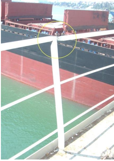
Çarpma neticesinde geminin vardavelasında ve filika kord nozulunda oluşan hasarlar
