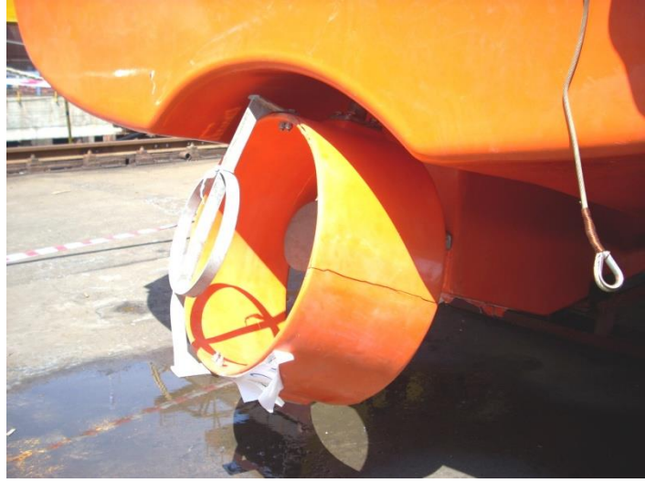
Çarpma neticesinde geminin vardavelasında ve filika kord nozulunda oluşan hasarlar
