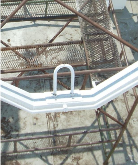
Filika mataforasındaki kord nozullu dümen topuğunun çarpmasıyla hasarlanan deniz bağı kelepçesi
